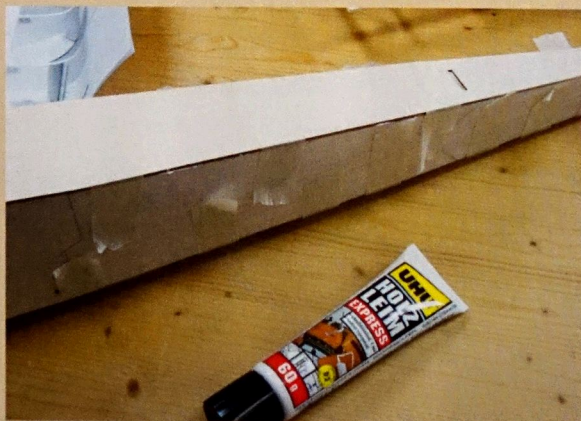
Der Rumpfboden wird nach dem Leimauftrag mit Klebestreifen gesichert
