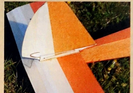
Das hält! Die Ruder sind mit Scharnierband aus Stoff angeschlagen
