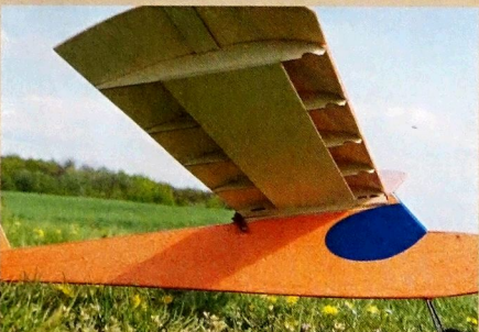
Die ungewöhnliche Tragflächenkonstruktion erzeugt im Flug ein hörbares Rauschen
