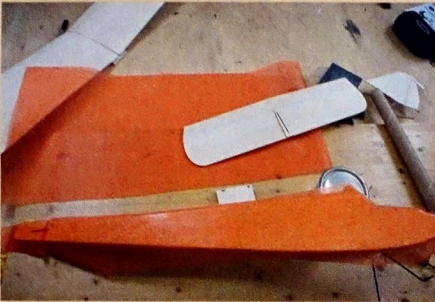
Nach alt' Väter Sitte wird Bespannpapier mit Tapetenkleister aufgeklebt
